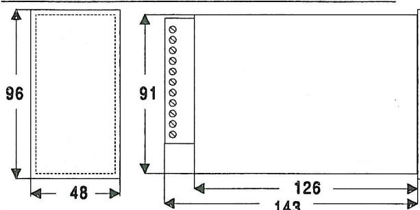
Gehäuse: Schalttafelgehäuse mit Spreizbügelbefestigung und Steckeinschub
