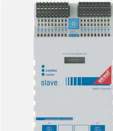
**Kompaktes combo Slave I/O Modul für den Anschluss an combo Master-Module und visio Control Panels.**
