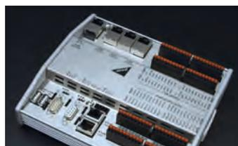
IEC 61131-3 Steuerungslösung mit I/O's und WEB-Server
