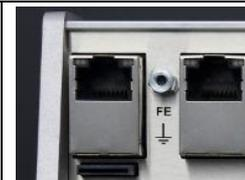
Als FE-Anschlussmittel sind insbesondere hochflexible Kupfergeflechtbänder / Massebänder sehr gut geeignet; diese sind unbedingt einer Kupfer-Einzelader vorzuziehen. Zur Montage wird eine M3-Schraube mit der Einbautiefe von 6 mm verwendet.
