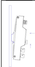
Das RMC5xx wird über die Hutschiene gehalten, sodass die Hutschiene im rechten Winkel zur Geräterückseite verläuft. Die Hutschiene darf hierbei nicht dicker als 1,5 mm sein.
