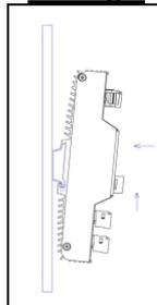
Das RMC500 wird über die Hutschiene gehalten, sodass die Hutschiene im rechten Winkel zur Geräterückseite verläuft. Die Hutschiene darf hierbei nicht dicker als 1,5 mm sein.
