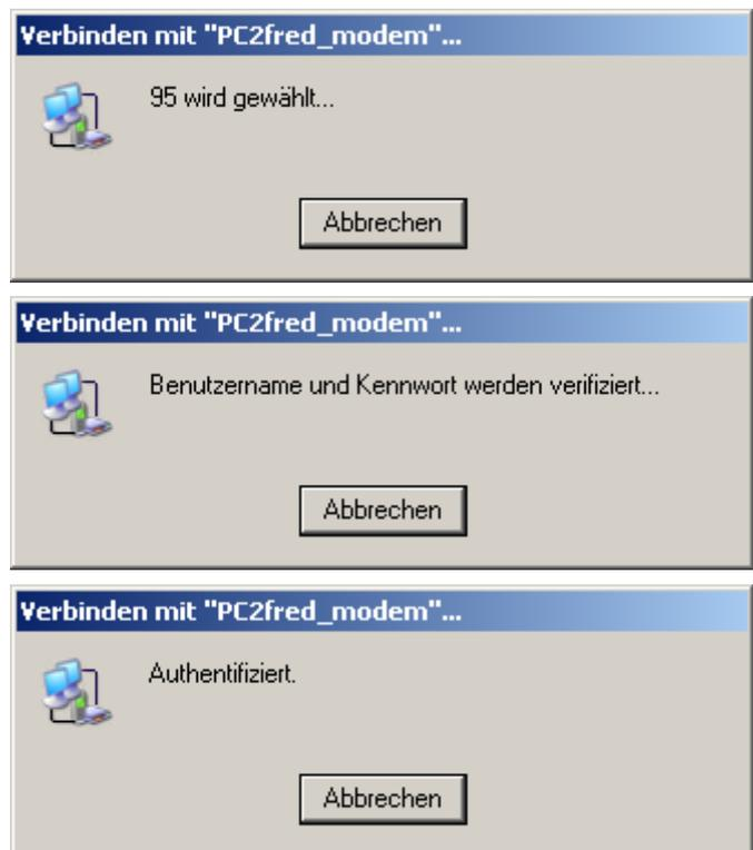
19. Nachdem Sie die Verbindung aufgebaut haben wird in der Anwendungsleiste das Icon
