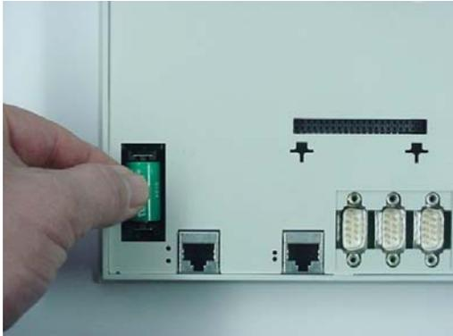
3. Die Batterie entnehmen. Zum leichteren Entnehmen, befindet sich an ihr eine Lasche, an der die Batterie herausgezogen werden kann.
