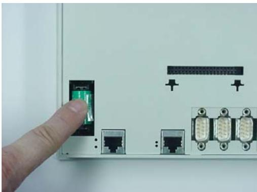
4. Setzen sie die neue Batterie unter Beachtung der Polarität ein (siehe Symbol auf dem Batteriesockel).
