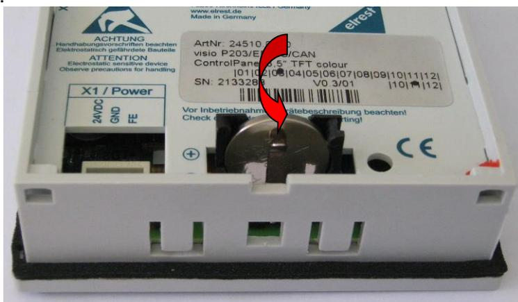
Die Batterie befindet sich auf der Geräterückseite. Um diese zu wechseln sind folgende Punkte zu beachten:
