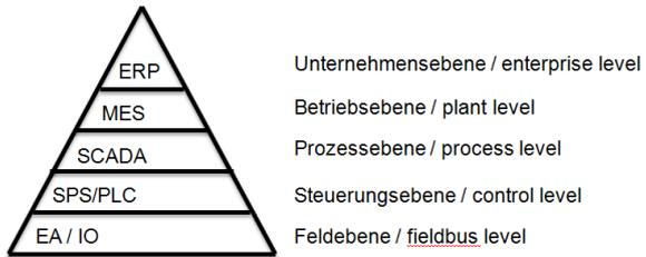
Die Kommunikation der Prozessebene zum Leitrechner erfolgt über OPC.
