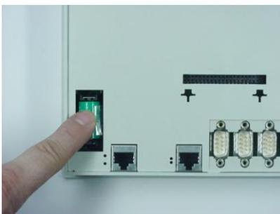
Setzen sie die neue Batterie unter Beachtung der Polarität ein (siehe Symbol auf dem Batteriesockel).
