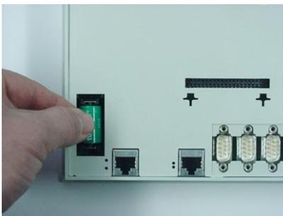
Die Batterie entnehmen. Zum leichteren Entnehmen befindet sich an ihr eine Lasche, an der die Batterie herausgezogen werden kann.
