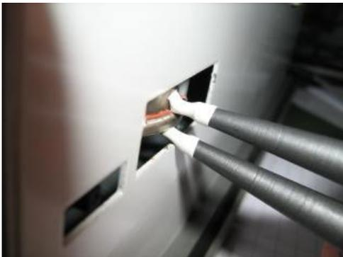
Die Zange ist so isoliert, dass selbst bei einem Nachgeben der unter Druck stehenden Isolierung zwischen den Backen der Zange maximal ein Potential berührt wird und kein Kurzschluss entstehen kann.
