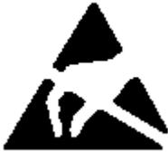
**EGB / ESD** können durch Spannungen und Energien zerstört werden, die weit unterhalb der Wahrnehmungsgrenze des Menschen liegen. Solche Spannungen treten bereits dann auf, wenn ein Bauelement oder eine Baugruppe von einem nicht elektrostatisch entladenen Menschen berührt wird. Bauelemente, die solchen Überspannungen ausgesetzt wurden, können in den meisten Fällen nicht sofort als fehlerhaft erkannt werden, da sich erst nach längerer Betriebszeit ein Fehlverhalten einstellen kann.
