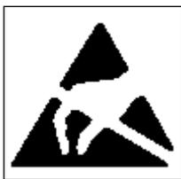
**EGB / ESD** können durch Spannungen und Energien zerstört werden, die weit unterhalb der Wahrnehmungsgrenze des Menschen liegen. Solche Spannungen treten bereits dann auf, wenn ein Bauelement oder eine Baugruppe von einem nicht elektrostatisch entladenen Menschen berührt wird. Bauelemente, die solchen Überspannungen ausgesetzt wurden, können in den meisten Fällen nicht sofort als fehlerhaft erkannt werden, da sich erst nach längerer Betriebszeit ein Fehlverhalten einstellen kann.
